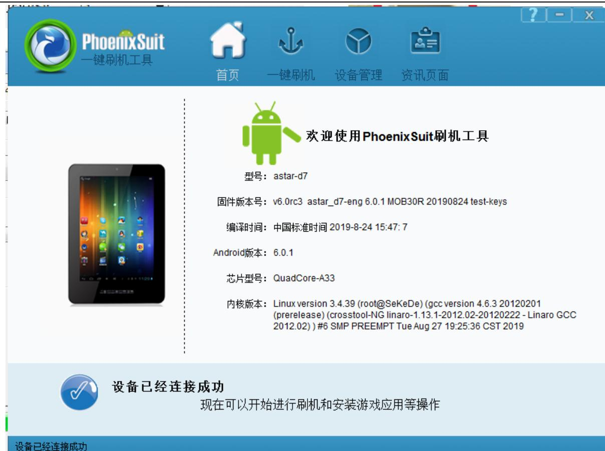
烧写操作需要首先通过 Micro USB 数据线连接主机和主板，在进行烧写时如果出现主机识别到新的设备没有正常安装驱动的情况时，需要手动安装设备驱动程序，驱动程序位于开发工具文件夹内。
